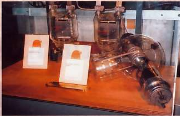
Drie triodezendbuizen (waaronder Amperex 833A) uit telegrafiezenders.
